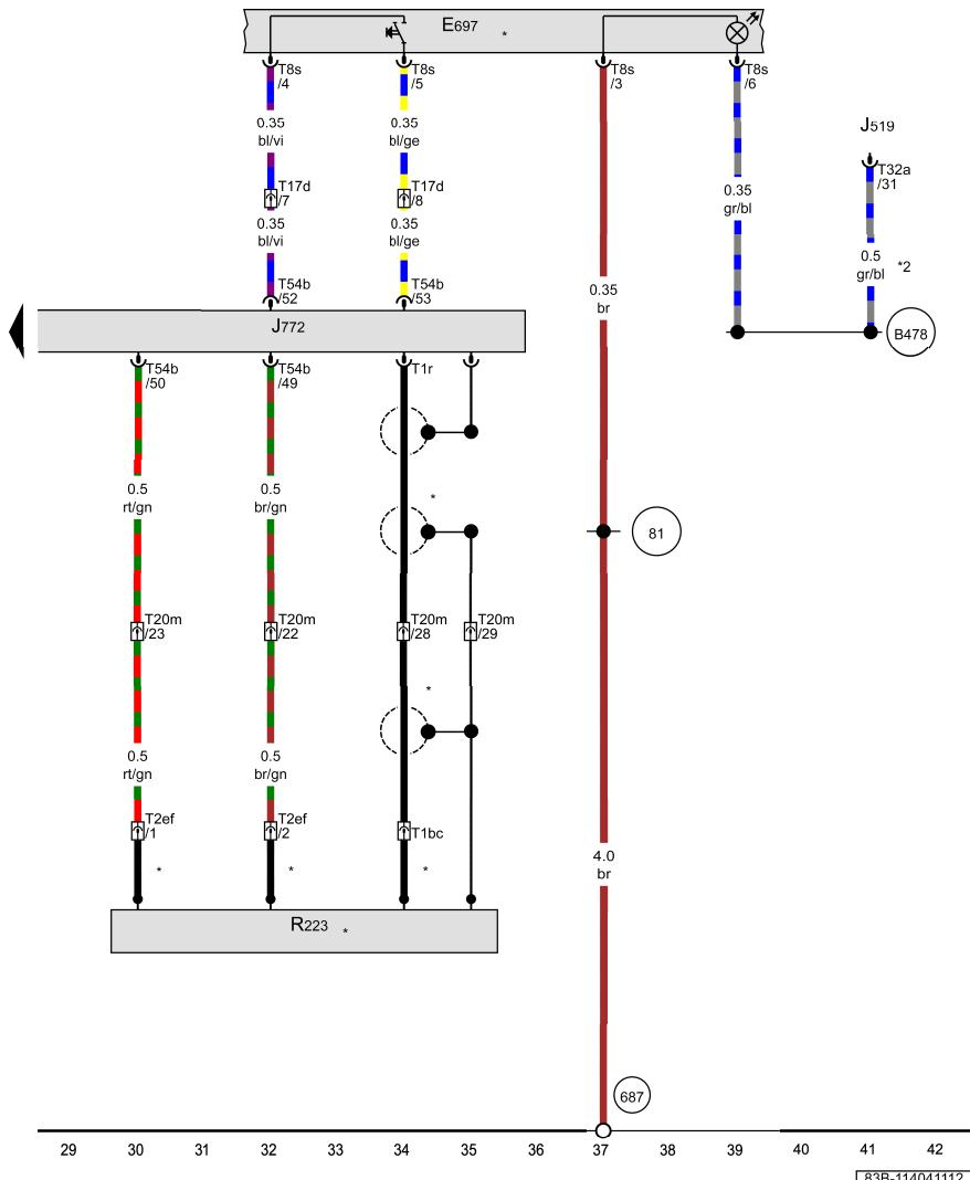
车载电网控制单元, 倒车摄像系统控制单元、保险丝, 外后视镜内
