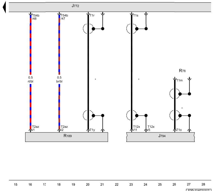
倒车摄像系统控制单元、保险丝, 电子通讯信息设备 1 控制单元, 倒车摄像头
